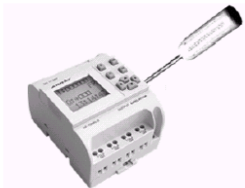
Rys. 2.2 Prawidłowe zdejmowanie panelu LCD
