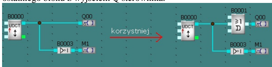
rys korzystne odseparowanie rozgałęzienia ostatniego połączenia
